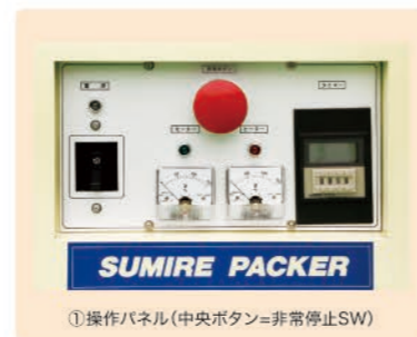
①操作パネル(中央ボタン=非常停止SW)
