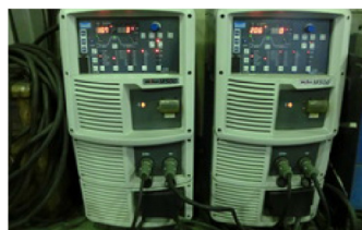
CO2半自動溶接機
