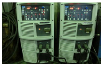
CO2半自動溶接機
