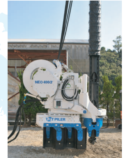
KOWAN製 TILT PILER NEO 400α (硬質地盤対応鋼管矢板圧入機) 〔2005年(平成17年)4月 土佐機械工業より パイラー事業の譲渡を受ける〕
