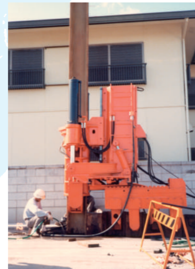
土佐機械工業が独自の技術で開発した「傾動装置」付 STILL WORKER 試作機 〔高知市長浜にて初施工 1982年(昭和57年)11月〕
