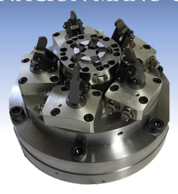
本装置はワーク芯出し用治具としてマノクランプ(ダイヤフラム式チャック)を使用し、ワークの芯出し把握後スラスト方式をロータリークランプシリンダにより、軸方向面を押さえ芯ブレ防止を目的としたクランプ治具です。
