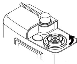
3. 電解補助液が入っている容器のキャップを取り外し電解補助液を補助液タンクに補充してください。
