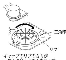
5. 補助液タンク収納カバー取り付けてください。
