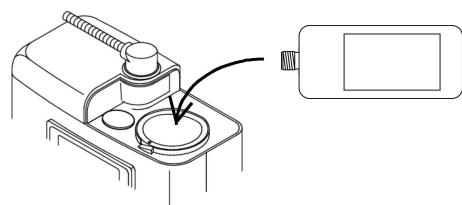
4. 補助液タンクのキャップを右に回し、取り付けてください。
