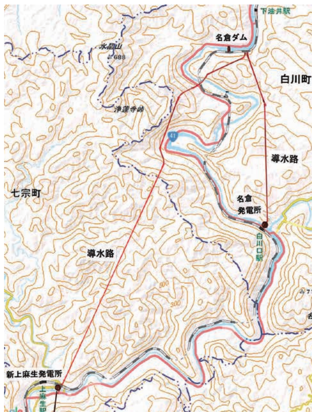
▲名倉ダムからの導水路
