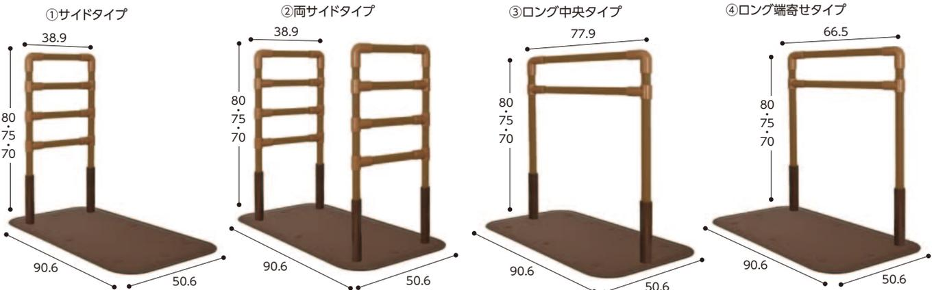
●重量／①19.7kg、②25.2kg、③19.9kg、④19.7kg ●耐荷重／100kg ●ベース厚み／0.9cm ●材質／手すりは樹脂被膜スチール、ベースはスチール
