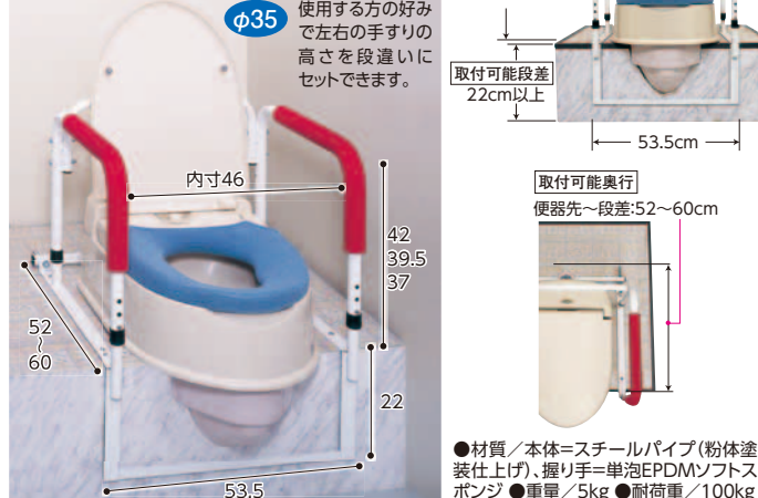
使用する方の好みで左右の手すりの高さを段違いにセットできます。 φ35 42 39.5 37 22 53.5 37・39.5・42cm (3段階) 取付可能段差 22cm以上 取付可能奥行 便器先~段差:52~60cm ●材質/本体=スチールパイプ(粉体塗装仕上げ)、握り手=単泡EPDMソフトスポンジ ●重量/5kg ●耐荷重/100kg ●取付有効段差高が22cm以下の場合、特注対応致します。 (在) ウェルファン
