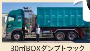
30m 3 BOXダンプトラック
