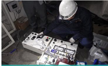
電気設備機器の耐圧試験
