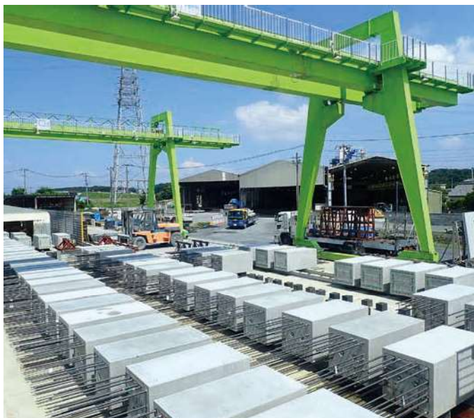
建築構造用RC部材SR-PCa製品工場
