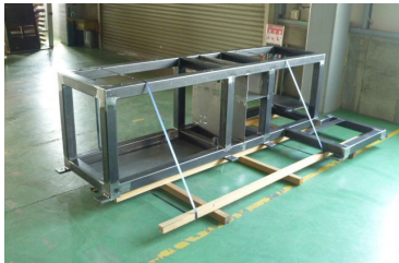
機械部品架台 SS製 WDH : 1500×800×650
