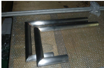
避難手摺 ステンレス丸パイプ WDH:600×300×27.2 SUS丸パイプカット+溶接+HL仕上げ
