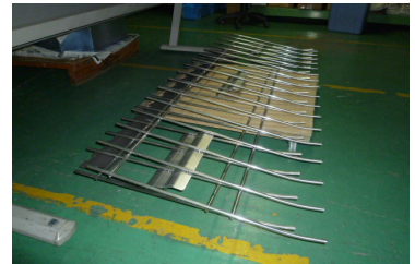
ステンレススノコ SUS丸棒φ15 WDH:2000×600×50 丸棒カット+曲げ+溶接
