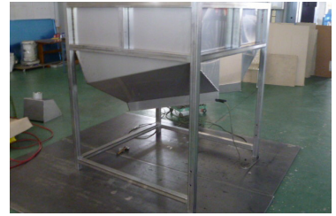
ステンレス製ホッパー・架台 SUS304製
