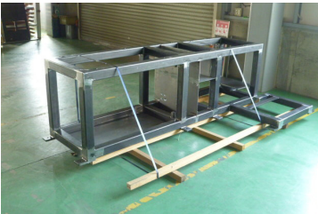
機械部品架台 SS製 WDH : 1500×800×650
