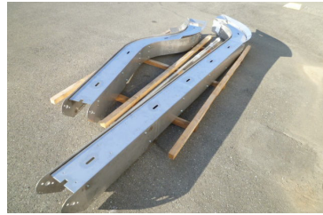
ステンレス製コンベヤ SUS304 t3.0 L=2500
