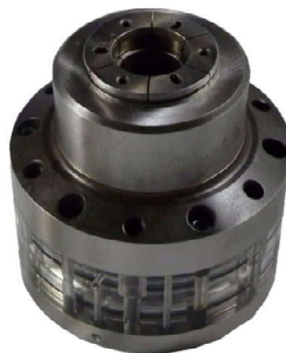
サブピストンのパイヨネット廻り止め部、メインピストン挿入し固定完了
