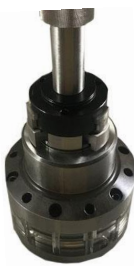
60° 旋回しパイヨネット構造とメインピストンと噛み合い本体取付完了
