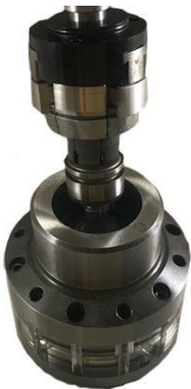
コレットをローダーまたは、ロボットにて本体挿入する
