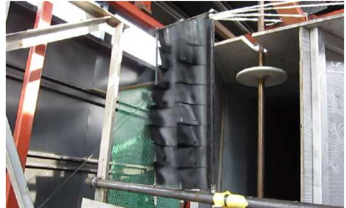
高分子材人工鳥翼風洞での耐久試験 風速50m/s 3時間
