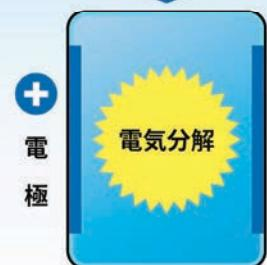
原水に微量の食塩と希塩酸を加えた状態で無隔膜電気分解を行うと、生成された水溶液は水酸化ナトリウム(NaOH)が塩酸により中和され、殺菌力の最も強い“微酸性”領域となり、「次亜塩素酸(HClO)」を主成分とした「微酸性次亜塩素酸水」となります。
