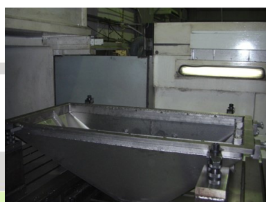
溶接後の仕上げ加工
