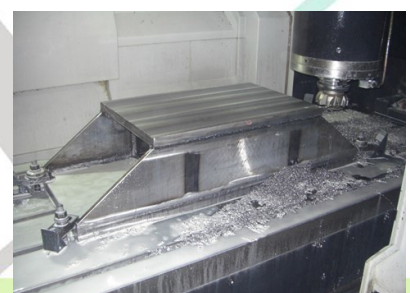
溶接後の仕上げ加工
