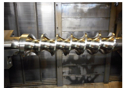
材質 SUS304 \phi 100 \times 400
