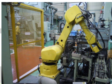
ロボットによるメカプレス自動化
