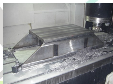
溶接後の仕上げ加工
