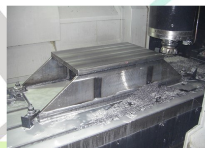
溶接後の仕上げ加工
