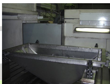
溶接後の仕上げ加工
