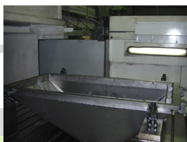
溶接後の仕上げ加工
