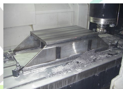
溶接後の仕上げ加工
