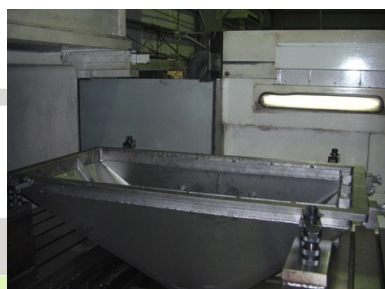
溶接後の仕上げ加工
