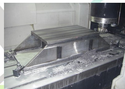
溶接後の仕上げ加工
