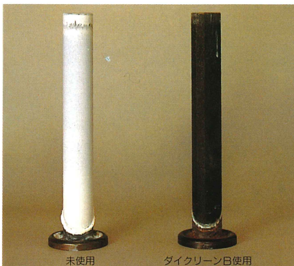
テストボイラーによる清缶剤のスケール防止効果
