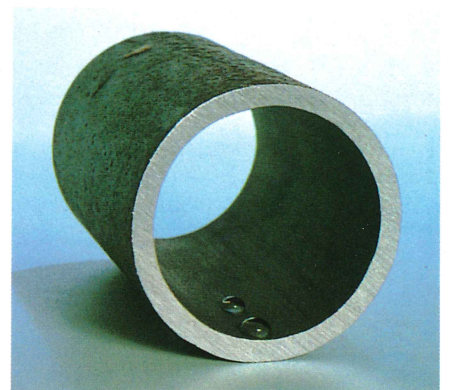
管内に撥水性の被膜が生成された状態
