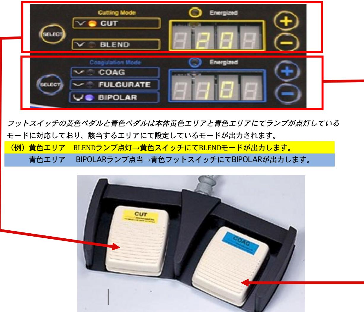
フットスイッチの黄色ペダルと青色ペダルは本体黄色エリアと青色エリアにてランプが点灯しているモードに対応しており、該当するエリアにて設定しているモードが出力されます。
