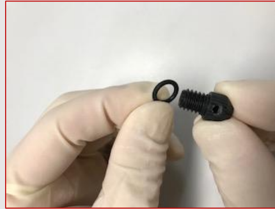
ワッシャーをチューブコネクターに装着 吸引ハンドルにチューブコネクター装着
