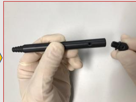
ワッシャーをチューブコネクターに装着 吸引ハンドルにチューブコネクター装着
