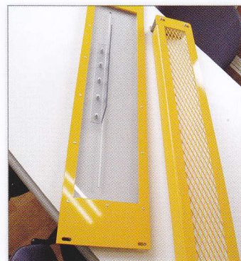
透明窓付き安全カバー 窓は透明塩ビ製。
