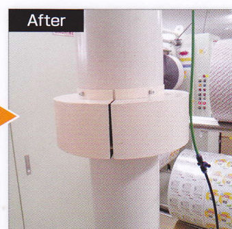
回転部が剥き出しだった為、カバーを製作。
