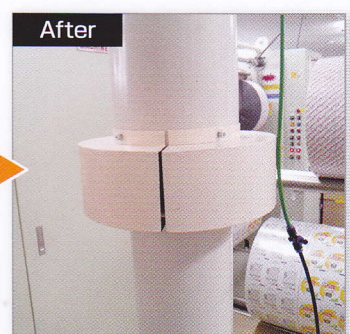
回転部が剥き出しだった為、カバーを製作。
