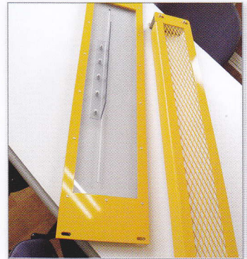
透明窓付き安全カバー 窓は透明塩ビ製。
