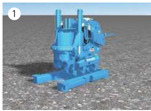
1 圧入機本体、反力架台を水平に設置
