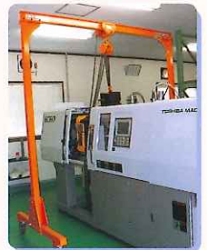
使用例：成形機への金型取付け・取外し
