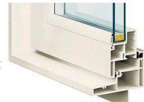
複層ガラスを構成する部品に「スペーサー」がありますが、日本製の複層ガラスのスペーサーはほとんどがアルミでできています。断熱性能を上げるためにスペーサーを使っているはずなのにその部材が熱を通しやすいアルミで作っているなんて本末転倒です。スペーサーの断熱性能を上げることで、窓全体の性能向上につながるのももちろんのことそれ以上に結露を防ぐという面で大きな意味を持っています。
